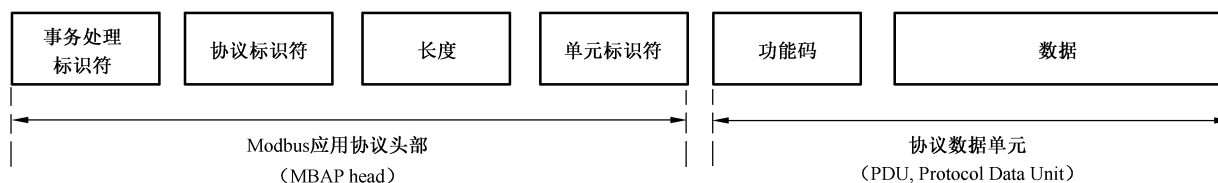
图 A.2 Modbus TCP 数据帧结构
