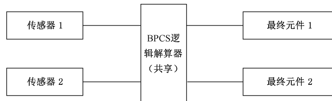
图 A.1 同一场景下多个回路的典型 BPCS 逻辑解算器
