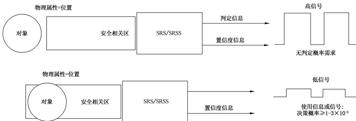
图 I.2 提供判定和置信度信息的 SRS/SRSS 示例
