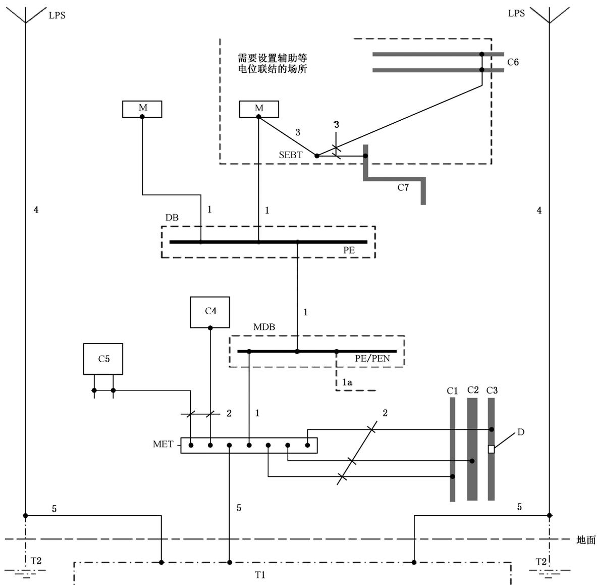
图 B.54.1 基础接地极和保护导体的接地配置示例
