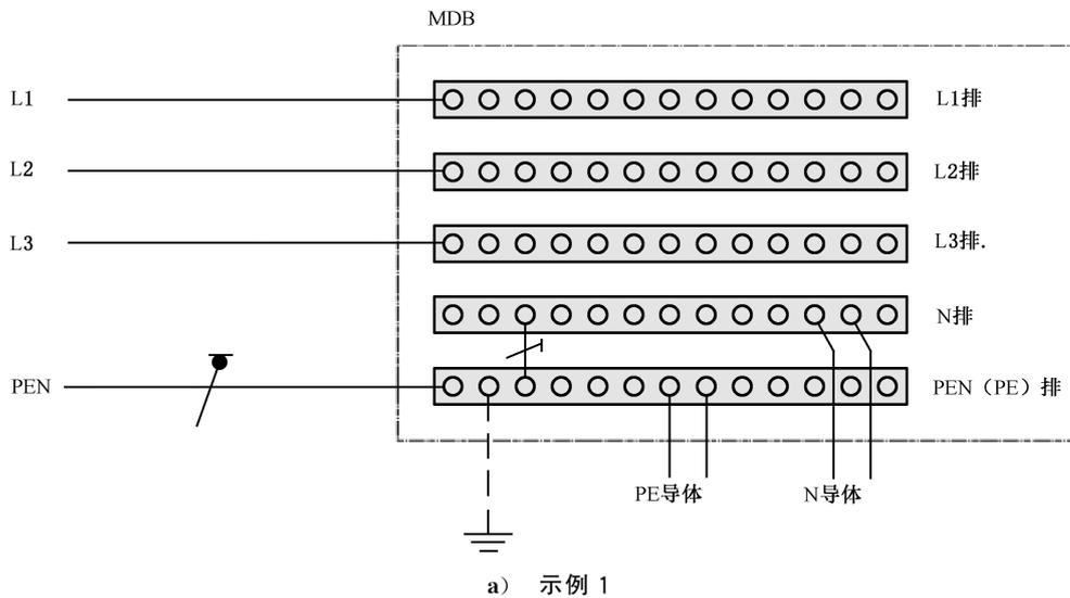
图 54.1 PEN 导体连接的示例
