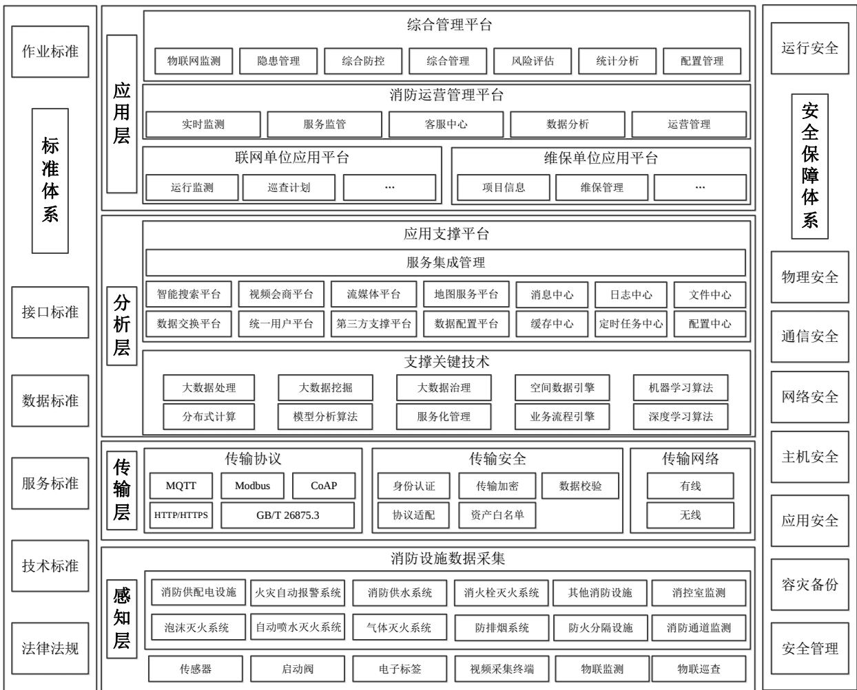
图1 消防物联网系统体系架构
