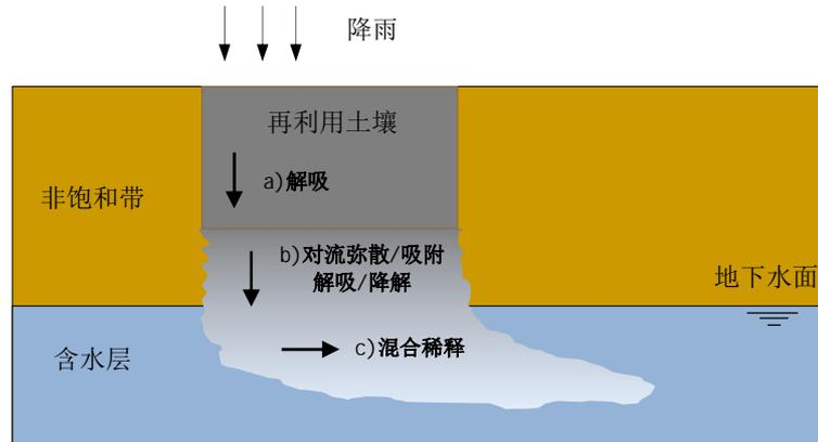
图2 污染场地修复后土壤再利用典型概念模型
