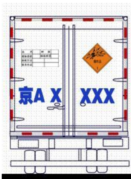
图 B.4 安全告示牌在厢式货车上的位置
