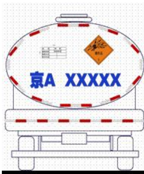
图 B.3 安全告示牌在罐式货车上的位置
