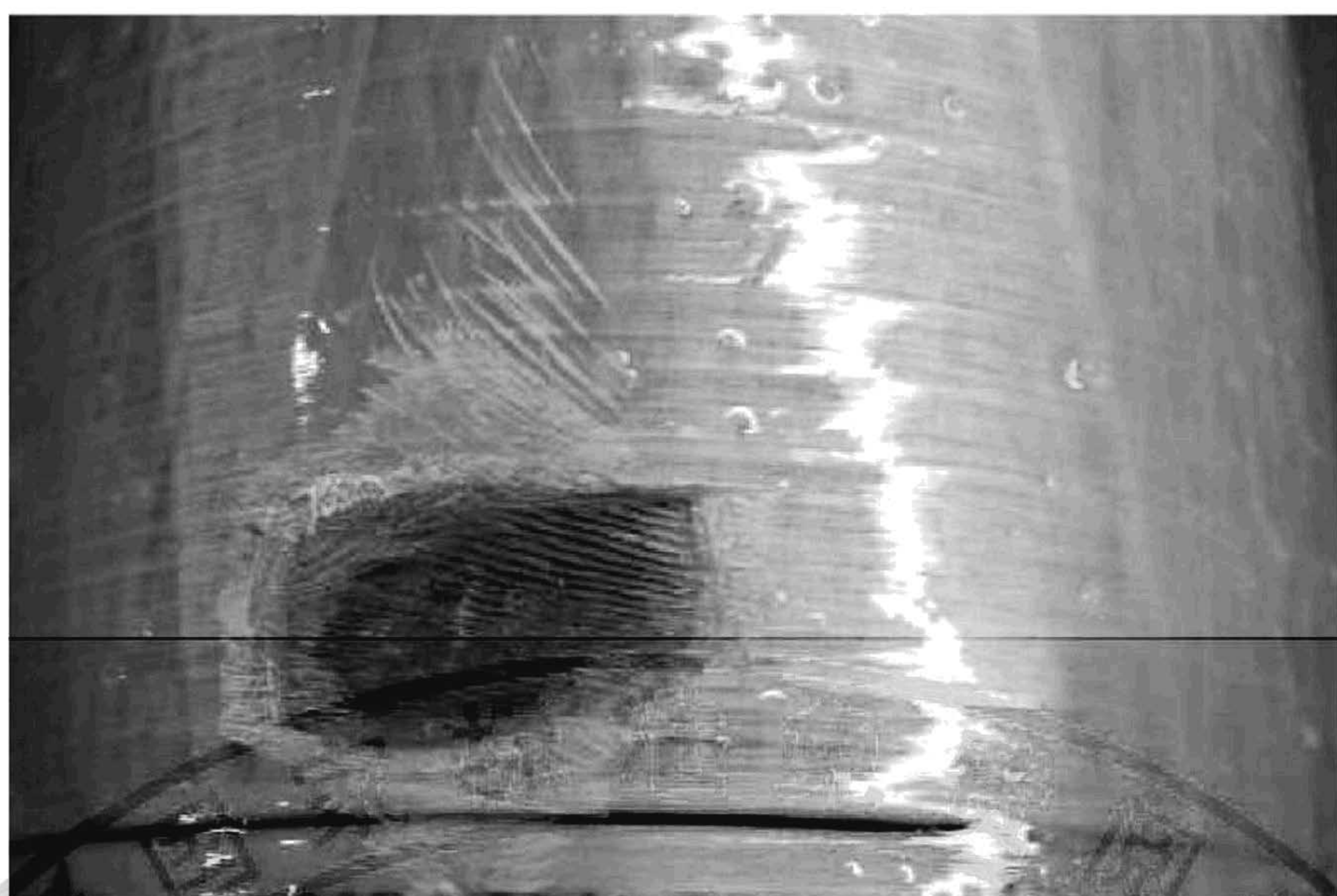
图 F.4 三级磨损(报废)
