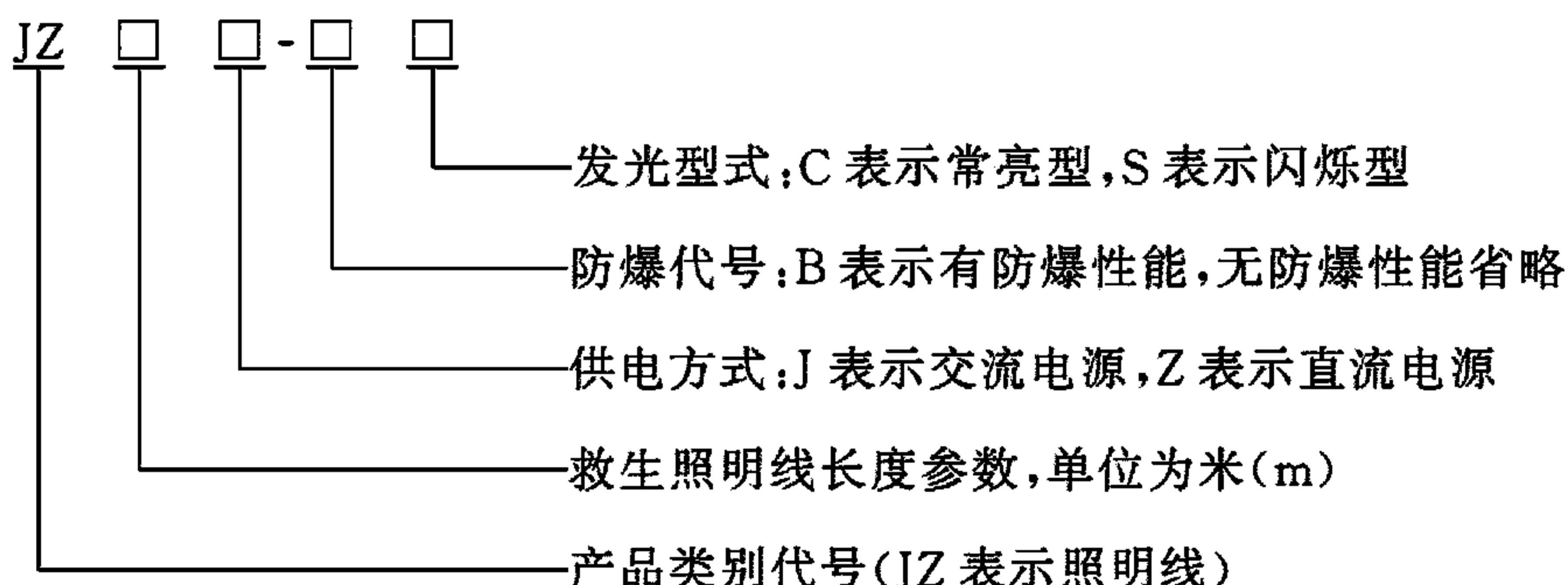
示例:JZ50J-BC 表示交流电源供电长度为 50 m 的具有防爆性能常亮型照明线。
