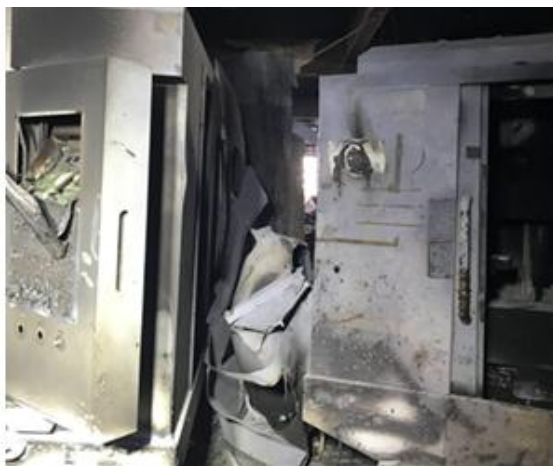
图 6 飞落至两台五轴打磨机中间夹缝处的机械手打磨机外罩盖板
