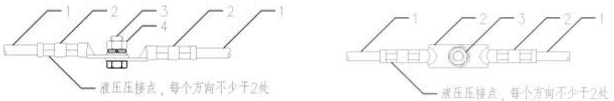
a) 接闪带连接处直通做法一立面图
