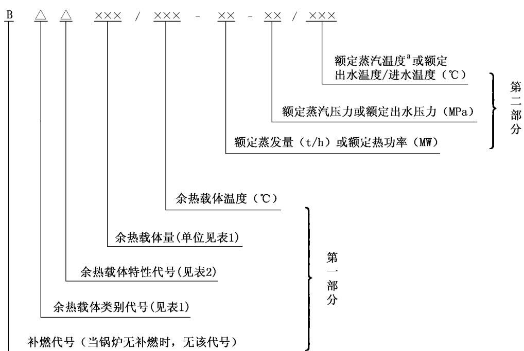
a 额定蒸汽温度为饱和温度时无该部分及斜线。
