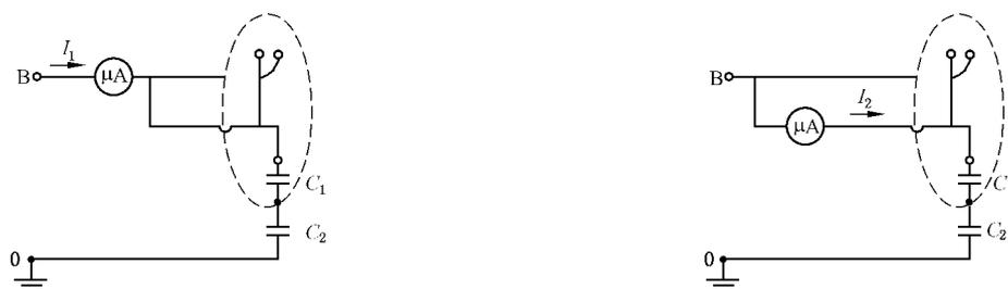
a) 流经屏蔽服装和人体的总电流测量原理
