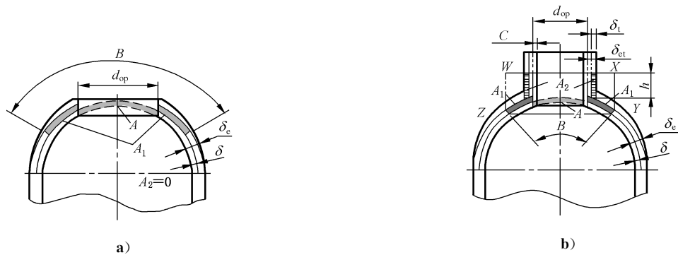
图 1 球壳中心开孔
