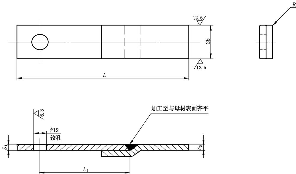
b) 以筒体母材为定位端的锁底接头替代圆形压头弯曲试样
