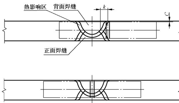
注 1:  $C \approx 0.25 \text{ mm} \sim 2 \text{ mm}$ 。
