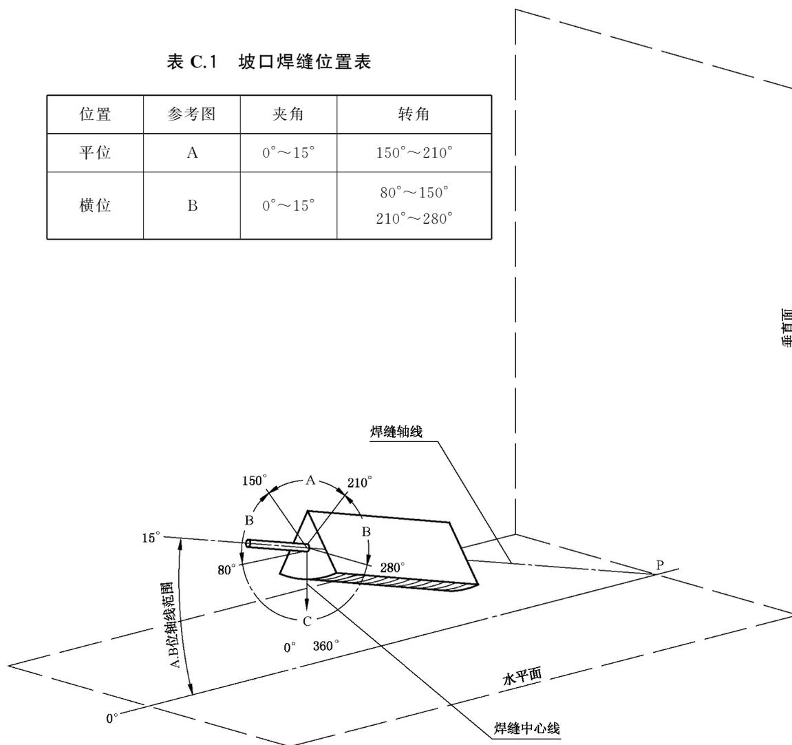
图 C.1 坡口焊缝位置图
