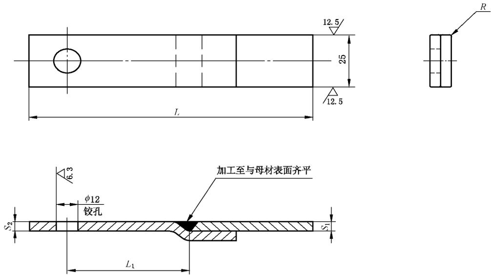
a) 以封头母材为定位端的锁底接头替代圆形压头弯曲试样
