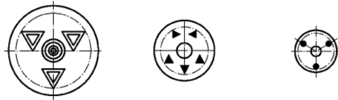
图 4 管状物和筒状物触摸危险位置示例
