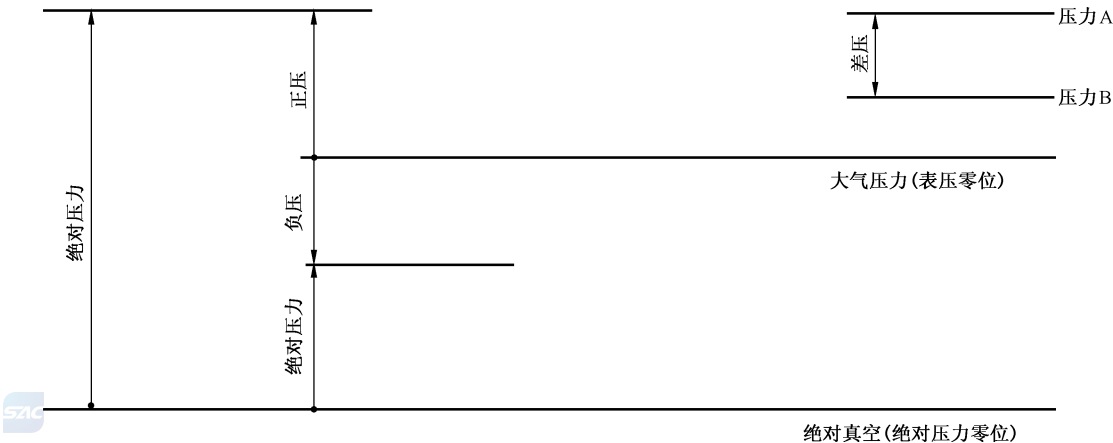
图1 压力的定义示意图
