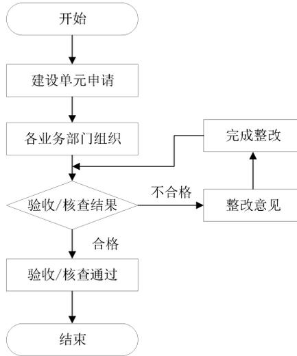
图 C.1 建设单元验收工作流程示意图
