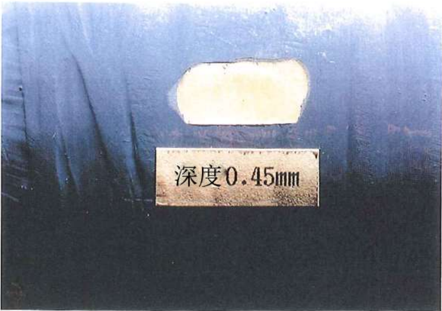
图 B. 3 二级损伤（可修复）
