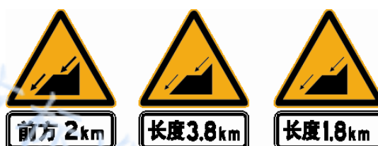
图22 长坡陡下坡标志示例
