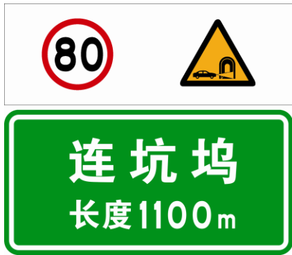
图8 长度超过 500 m 的隧道预告标志示例
