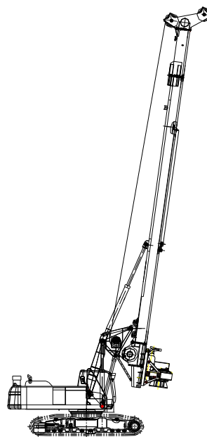
图 9 平行四边形结构钻机拆卸（4）
