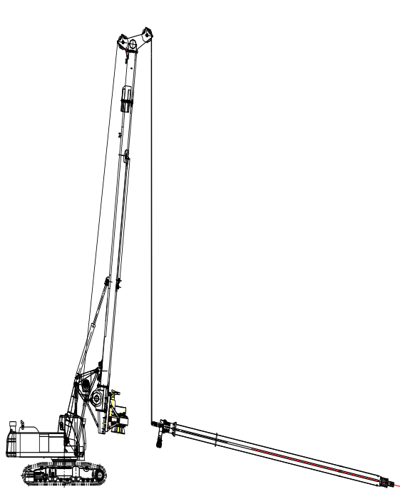
图 4 平行四边形结构钻机安装（4）
