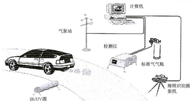
图 C.1 遥测设备安装示意图
