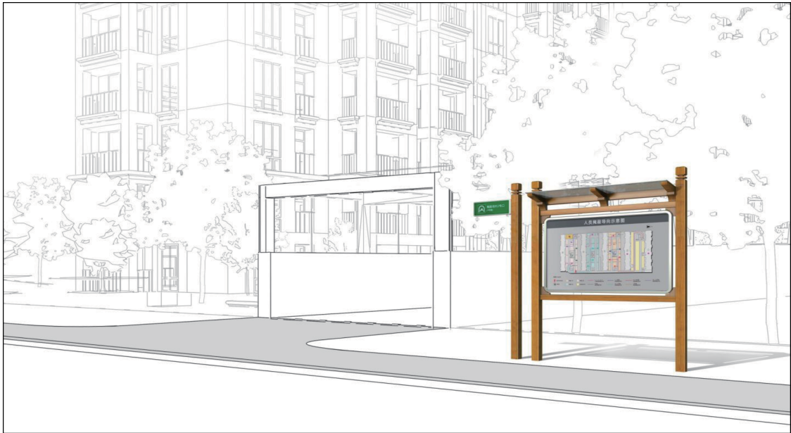
图 B.1 人员掩蔽工程入口处设置的位置标志和人员掩蔽导向示意图示例
