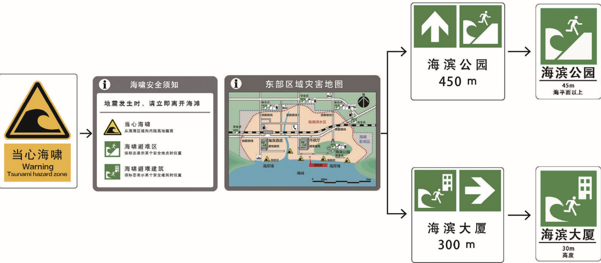
图 3 海啸疏散标志系统的构成示意图
