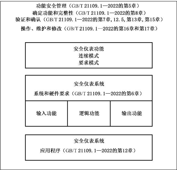
图 A.4 系统、SIS 硬件和 SIS 应用程序的关系
