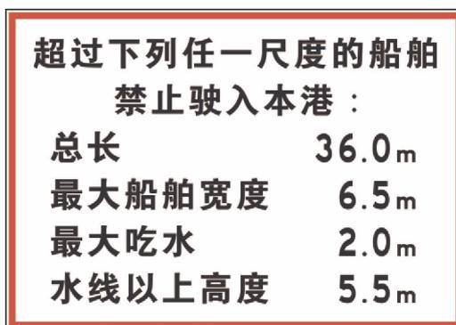
图 47 限制船舶尺度标志(代码 410)示例
