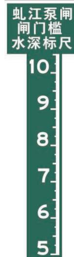
图 87 闸门槛水深标尺(代码 1002)示例
