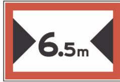
图 41 限制船舶宽度标志(代码 401)示例
