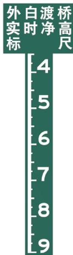
图 86 实时净高标尺(代码 1001)示例
