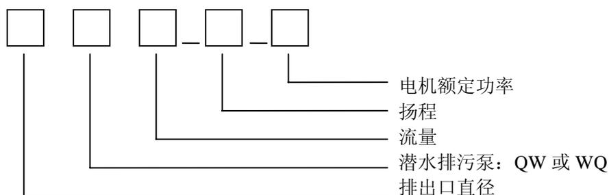
示例: 50QW15—22—3 指泵排出口径为 50mm, 流量为 15m<sup>3</sup>/h, 扬程为 22m, 额定功率为 3kW 的潜水排污泵。
