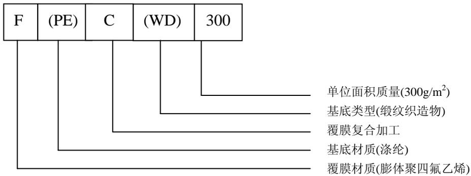
B4 消静电覆膜涤纶针刺滤料
