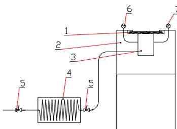
图 1 覆膜牢度测定装置示意图
