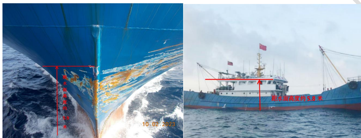
图14：“BBC ONYX”轮碰撞痕迹高度与 “闽连渔60996”轮罗经甲板高度对比示意图
