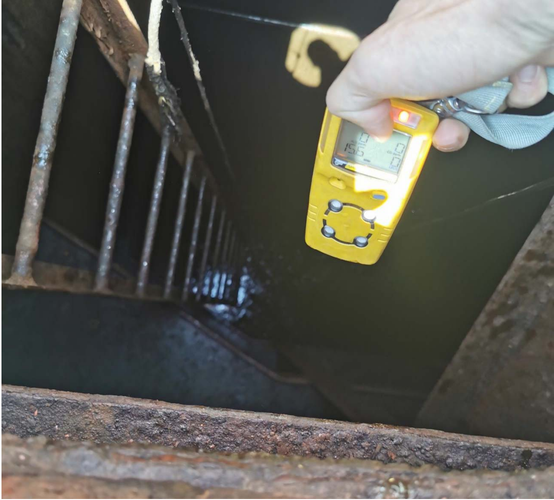
图 5：现场检测舱口处气体含氧量为 15.6%
