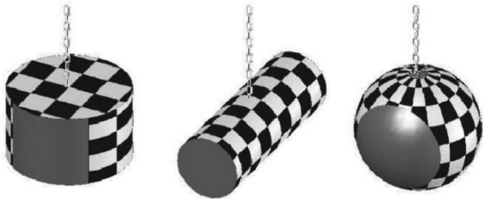
图 C.2 标出冲击区域的硬物体示例
