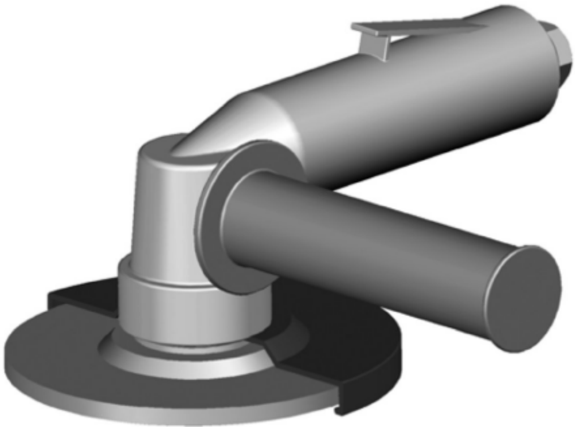
图 3 马达作为主柄的角式气动砂轮机
