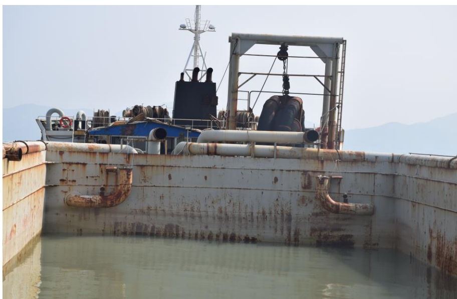
图 3：货舱前端溢流管示意图（摄于姊妹船“中科航 8”）
