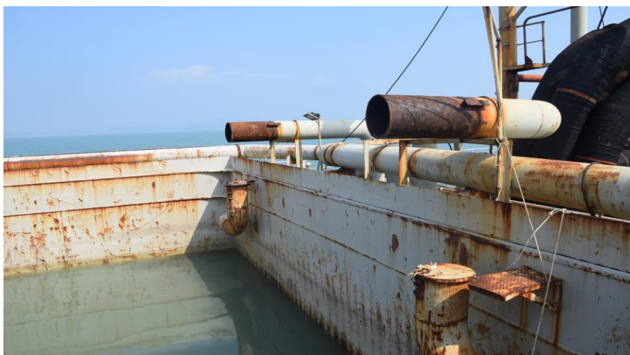
图 4：货舱后端溢流管示意图（摄于姊妹船“中科航 8”）
