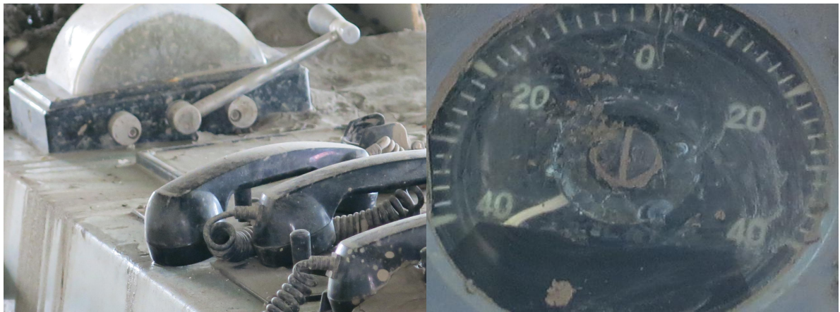
图 7：“长平”轮沉船车、舵勘验
