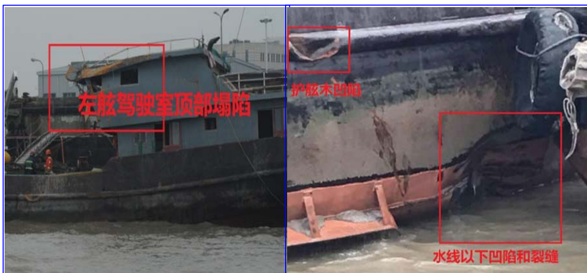
图11：“苏灌渔13144”轮起浮后船体受损情况
