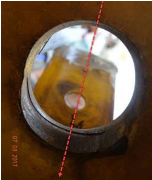
图3-4右顶升销轴孔边塑性变形
