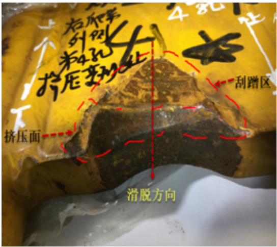
图3-5 右顶升爬梯第四孔形貌
